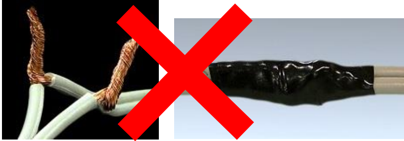
(写真)コードのねじり接続の様子
